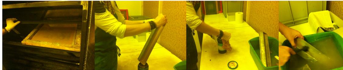
Sieb mit Rakelseite nach oben in den Trockenschrank legen ca. 30 Minuten trocknen lassen
